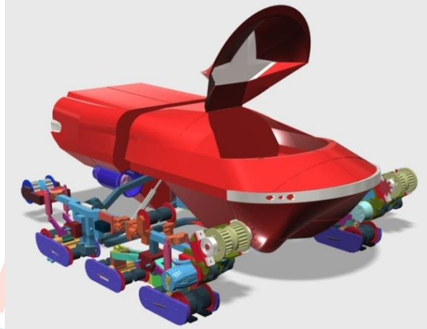
Resim 6. Afetzedelerin nakli için kullanılan kapağın açılması
