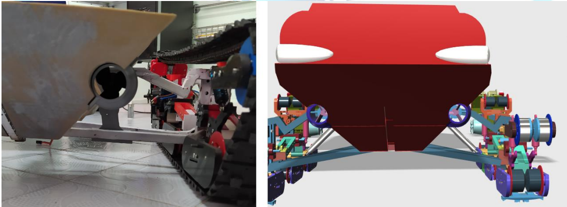
Resim 4. Hidro jet motorların Tank üzerindeki tasarım ve prototip görüntüsü
