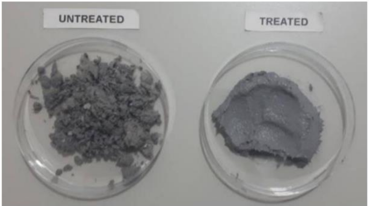
Şekil 2. Untreated (ham kağıt çamuru) ve Treated (Epicellulyse XT ile muamele edilmiş) çamur arasındaki fiziksel farklılık
