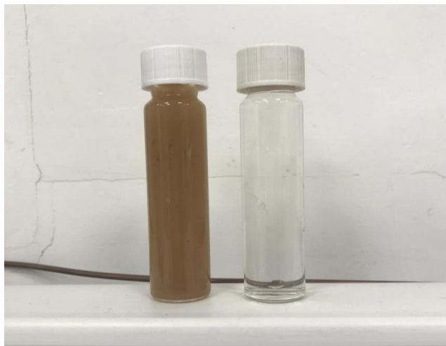
Şekil4.4. Atık suyun filtrasyon öncesi ve sonrasına ait görüntüsü [4]
