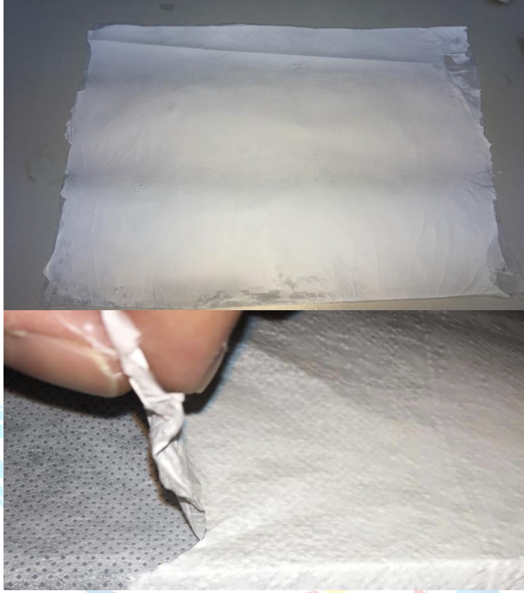
Şekil 4.3. LDPE-Akrilik Elyaf atıklarından elektrospinning işlemi ile üretilen Membran [4]
