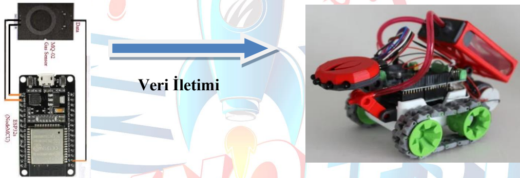
Şekil.5 Yangın verisinin robotumuza kablosuz iletimi
