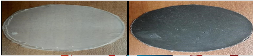
Şekil 2. Elde edilen polimer ve metal polimer kompozit disk örnekleri
