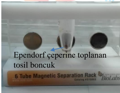
Şekil 5 : Manyetik tosil aktive boncukların manyetik rak yardımı ile miktarıs etrafında toplanıp süpernatanttan manyetik boncukların ayrılmasına olanak verdiği gösterilmektedir.
