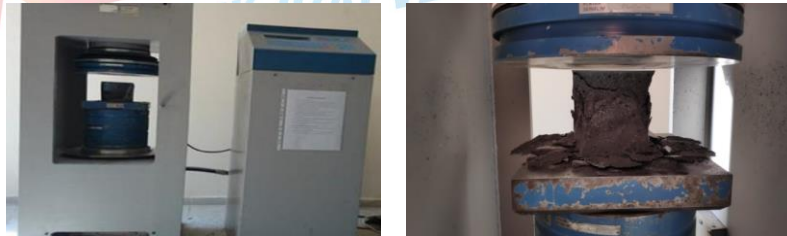
Resim 6. Basınç Presi ve kırılan numune
