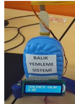
(Fotoğraf-4) 3 ayağın alt kısmına ise 16x2 led ekranı ve alarm sabitlenir.
