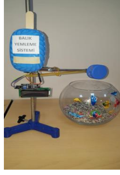
(Fotoğraf-6) Mblockda geliştirilen yazılım arduinoya yüklenir ve sistem çalışır hale getirilir.
