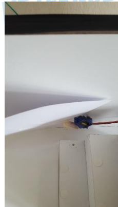
(Fotoğraf-3) Merdiven ile duvarın keşiştiği yere rampayı temsilen kullanılan karton, servo motora sabitlenir.
