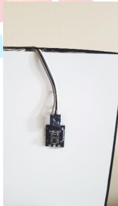
(Fotoğraf-2) Merdiven maketinin duvar kısmının basamak sonu kısmına buton sabitlenir. Açık olan rampa bu buton ile kapatılır.
