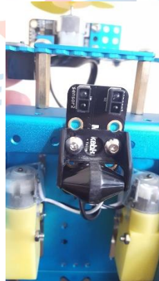
(Fotoğraf-3) Çizgi izleme sensörü robota sabitlenir
