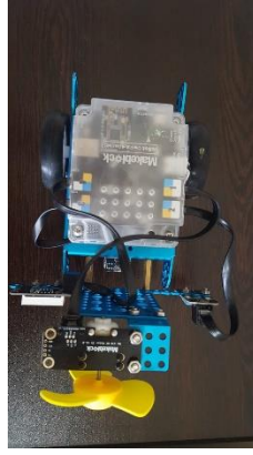
(Fotoğraf-6) Robota sabitlenen 4 bileşen robotun m-core kartına takılır..
