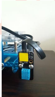
(Fotoğraf-2) Sıcaklık nem sensörü robota sabitlenir.
