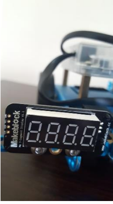
(Fotoğraf-5) 7 segment display sensörü robota sabitlenir
