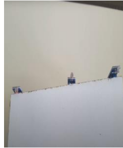
(Fotoğraf-2) Kutunun bir kenarına aynı hiza üzerine 3 adet ışık sensörü (ldr) sabitlenir.
