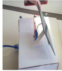
(Fotoğraf-3) Kutunun üst orta noktasına servo motor, servo motorun üzerine güneş paneli sabitlenir.
