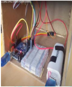
(Fotoğraf-5) 3 adet ldr ve servo motor breadboard kanalıyla arduino unoya bağlanır.
