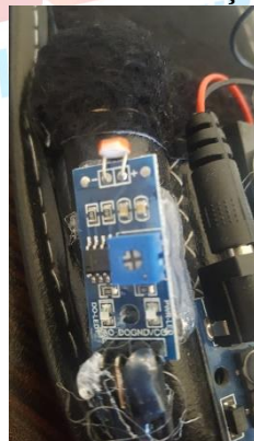
(Fotoğraf-2) Terliğin üst kısmına ldr ışık sensörü sabitlenir.
