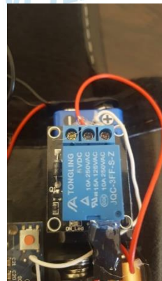
(Fotoğraf-3) Ampülün yanması ve dışarıdan güç ihtiyacını karşılamak için röle ve rölenin altına pil bağlanır.
