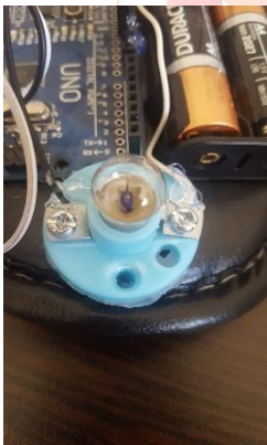
(Fotoğraf-1) Önü kapalı ev terliğinin ucuna, duyuna deney ampülü takılmış mekanizma yerleştirilir
