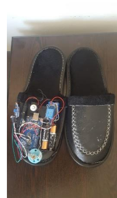
(Fotoğraf-4) Terliğin üzerinde yer alan toplam 4 komponentin bağlantısını arduino uno üzerinde gerçekleştirilir.
