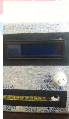
(Fotoğraf-2) Kutunun ön yüzüne 10 adet led lamba, buzzer, lcd ekran ve ses sensörü sabitlenir
