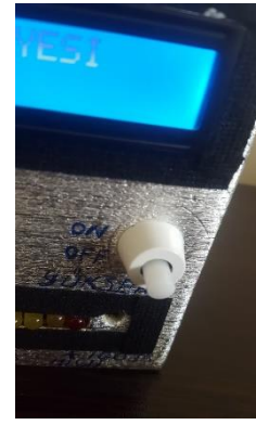
(Fotoğraf-4) Sistemin çalışabilmesi için 9 voltluk pil arduino unoya takılır ve pil enerji akışı sabitlenen buton ile sağlanır
