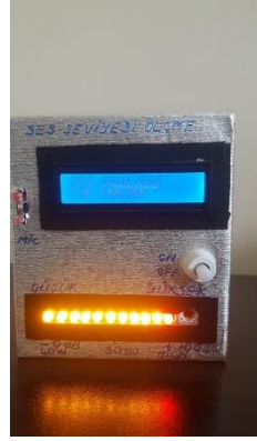
(Fotoğraf-5b) Mblockda geliştirilen yazılım arduinoya yüklenir (Ses Seviyesi 100dB üstüne çıktığı an)
