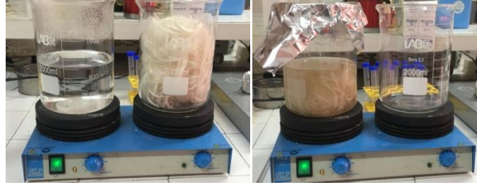
İpeğin Serisinden Uzaklaştırma İşlemi (Degumming)
