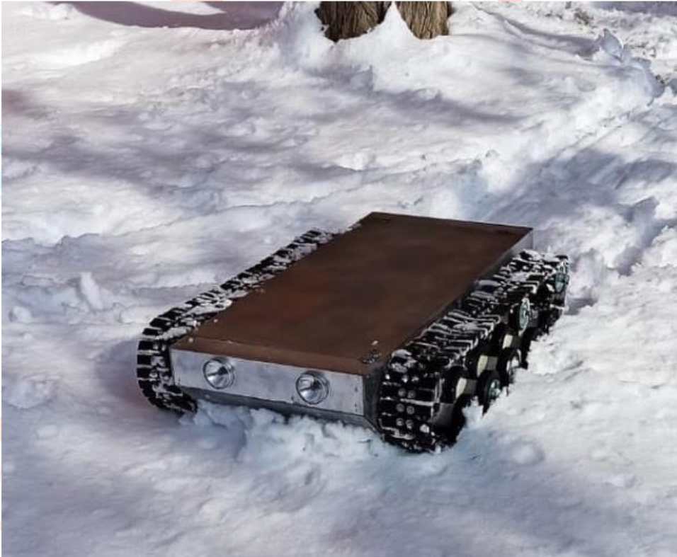
Şekil 1. Paletli aracın karda test edilmesi
