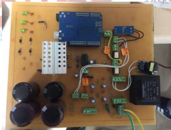
Şekil 8.5. Yerleşik Şarj Ünitesi Devresi
