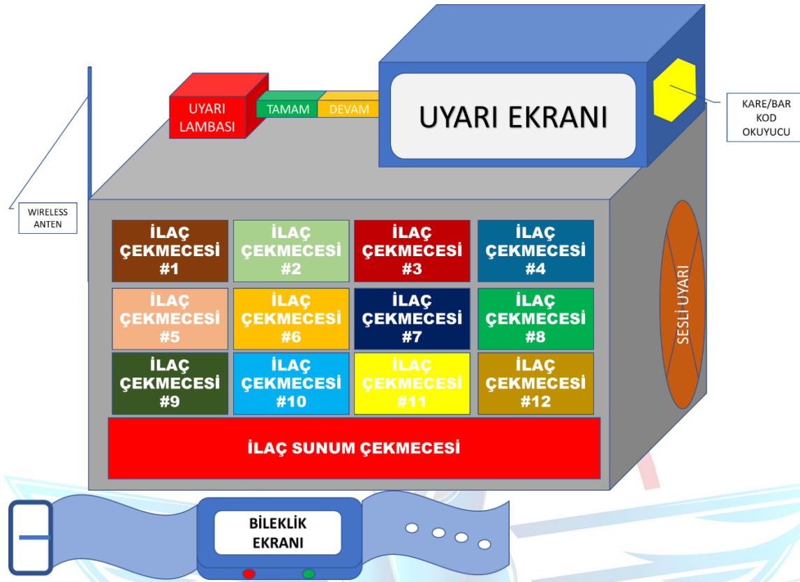
Şekil 3 Prototip ASK Cihazı ve ASK Bileklik
