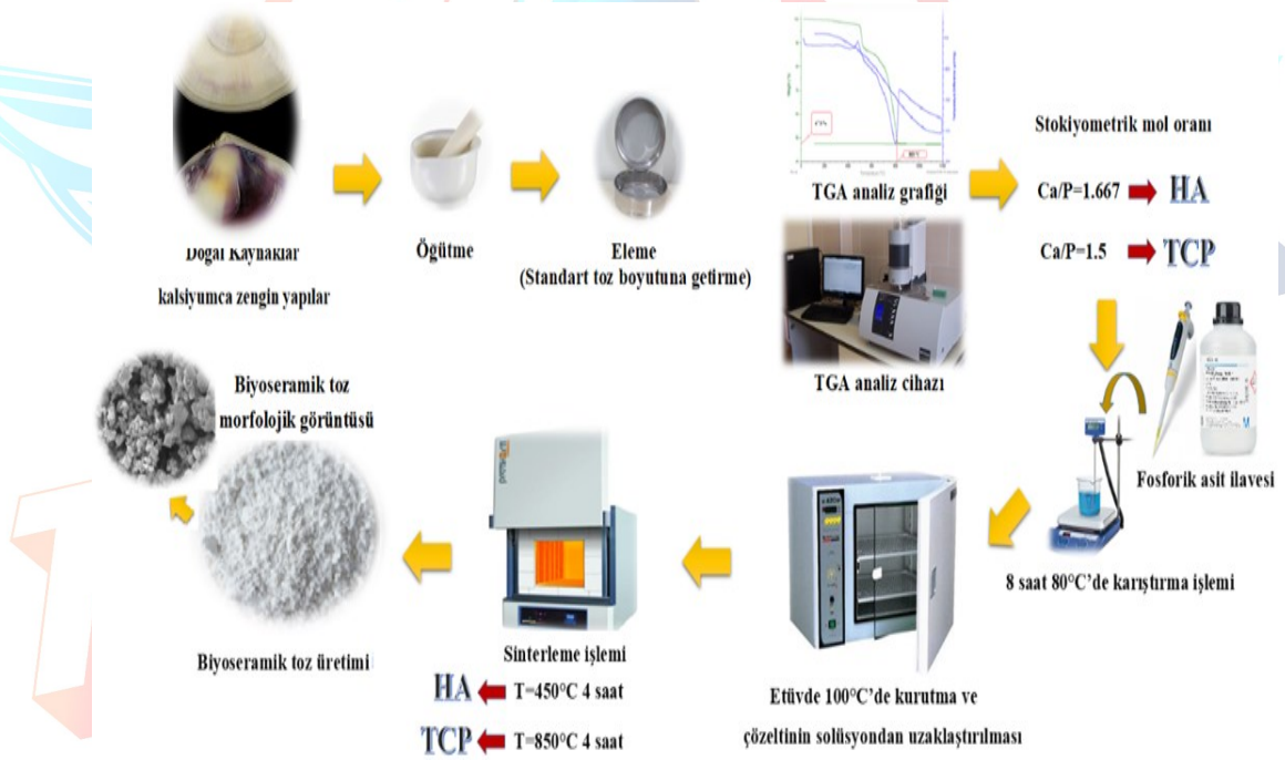
Şekil 4.1 Doğal kaynaklardan hidroksiapatit kemik tozu sentezi
