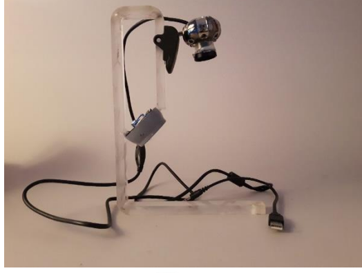
Resim – 4 Led Grubu ve Webcam Sabitlenerek Oluşturulan Sistem
