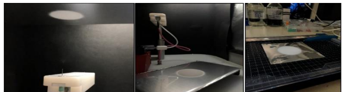
Şekil.a) Karışımın püskürtülmesi ve filmin oluşumu b) Bir doz püskürtülmüş film c) Katlanmaya hazır film
