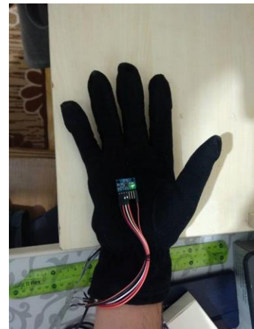
Şekil 3.2 Akıllı Eldiven üzerindeki MPU6050 sensör
