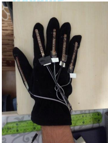
Şekil 3.1 Akıllı Eldiven üzerindeki flex sensörler
