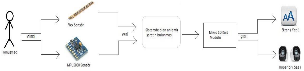
Şekil 3.4 Eldivenin Çalışma Prensibi
