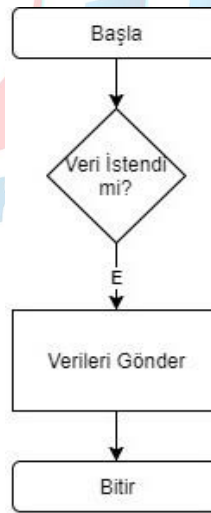
Şekil 3: Sunucu Üzerinde Yürüyen Mobil Ve Web İsteklerini Yürüyecek Akış Şeması.
