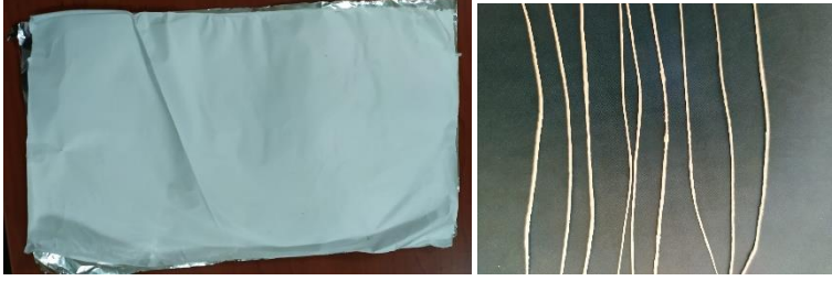
Şekil 3. PVA nanofiberlerin (a) membran hali ve (b) eğirme sonunda ameliyat ipliklerinin fotoğrafı.
