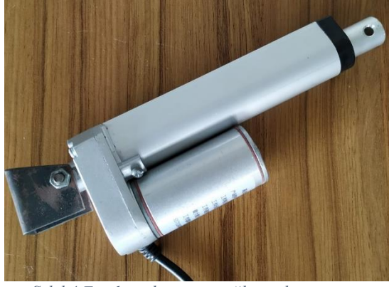
Şekil 4 Frenleme kuvvetini sağlayan lineer motor
