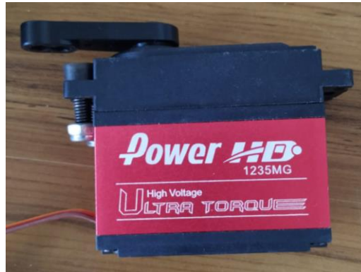
Şekil 3 Direksiyon dişlisinde kullanılan servo motor
