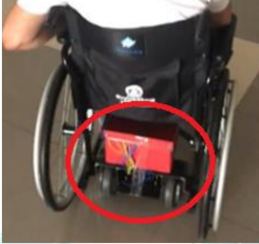
Şekil 2. HTS-01 ve redüktörlü fırçalı DC hub motor.
