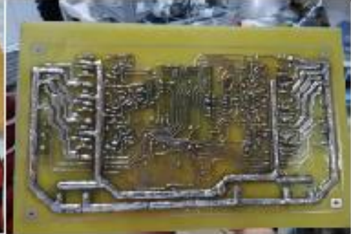
Şekil 3. HTS-01 elektronik kart tasarımı.
