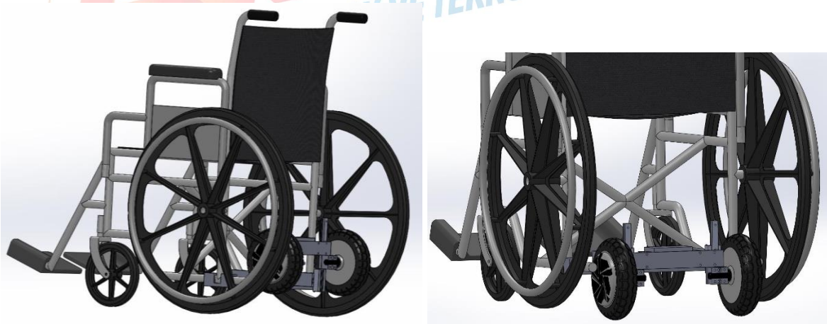
Şekil 7. HTS kiti takılı tekerlekli sandalyenin a) manuel kullanım hali b) elektrikli kullanım hali.
