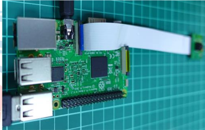
Şekil 2- Raspberry Pi Kamera Modülünün Bağlanması
