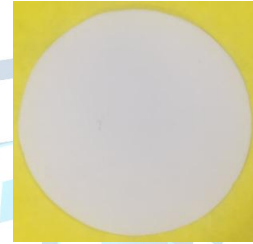
Resim 6. Yanma deneyleri için kesilen 9.5 cm çaplı geri dönüştürülmüş kâğıt örneği
