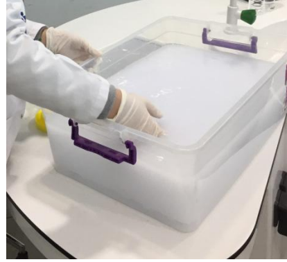
Resim 2. Blendırdan geçirilen materyallerin 20 L suyun içine konulması
